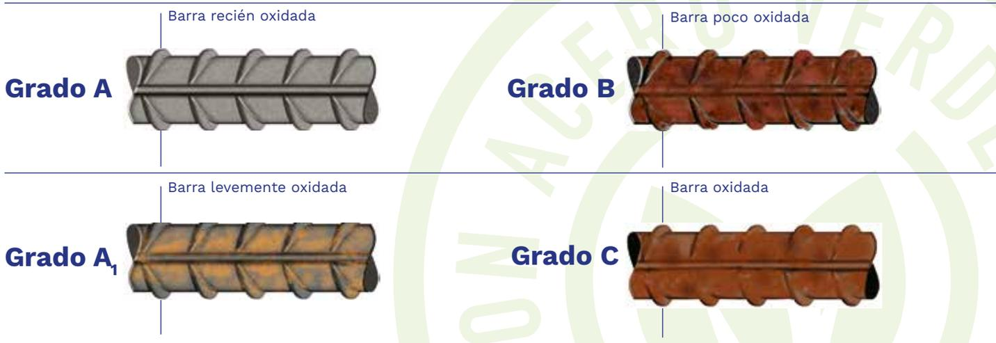
Grados de oxidación permitidos según norma NCh204 Of.2021.
